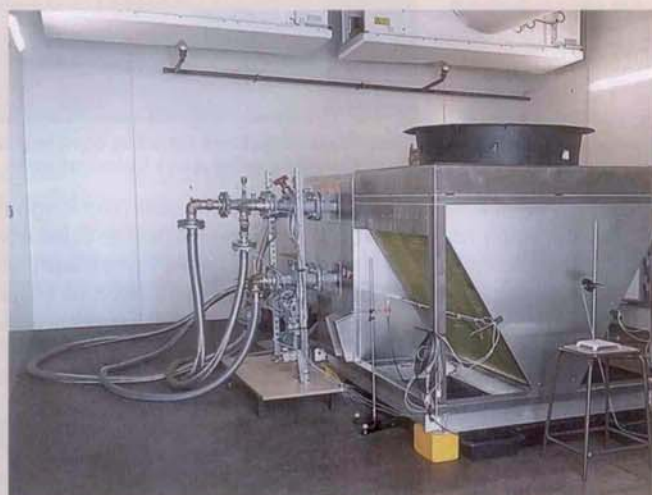
Prototype testé dans l'enceinte climatique négative du Pôle Cristal : il s'agit du modèle de plus petite puissance à un seul circuit et hélicoïde (doc. ETT).
