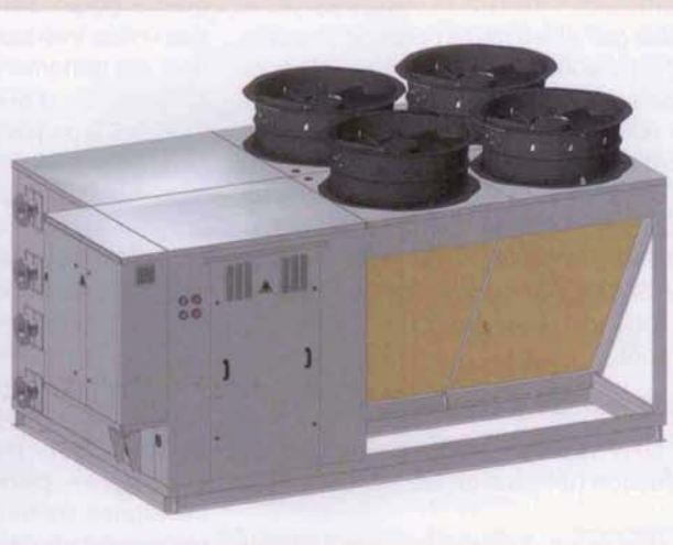
Image de synthèse du châssis des modèles Ecops 180-240-270, avec 2 circuits et 4 hélicoïdes : le compartiment technique est équipé d'un détecteur de fuite, le tableau électrique IP54 est séparé (doc. ETT).
