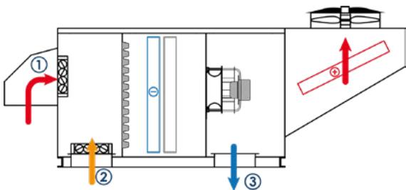
**Mode Climatisation** : Maintien de la température de confort l'été par le système thermodynamique.
