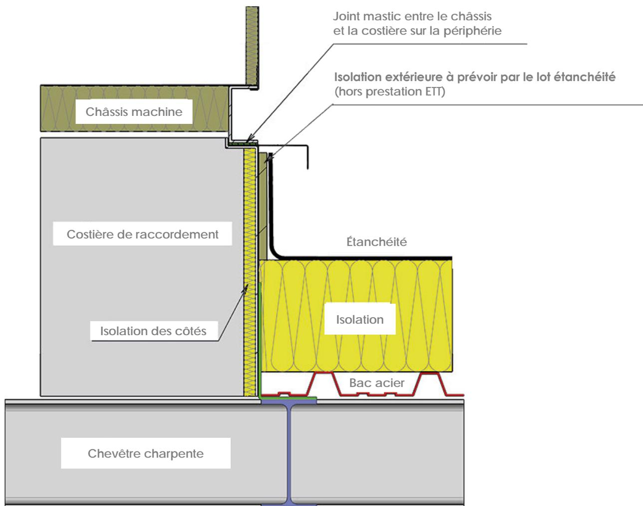
**Nota :** Les costières sont prévues pour une hauteur maximale totale de bac acier et d'isolant de 345 mm. Pour pouvoir garder une hauteur de costière standard (se référer au plan de costière), il faut vérifier suivant la pente du toit sur site, que la cote de hauteur « isolation et bac acier » laisse une hauteur d'étanchéité suffisante conformément au DTU 43.1.
