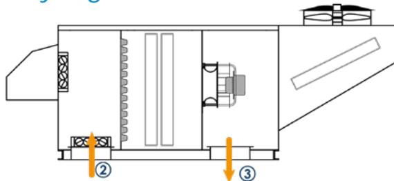
**Mode Recyclage** : Destratification du volume traité par recyclage, lorsque la température de reprise est nettement supérieure à la température ambiante en hiver.
