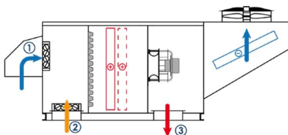
**Mode Chauffage** : Maintien de la température de confort l'hiver par le système thermodynamique et par les appoints (option).
