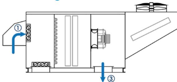
**Mode Free Cooling** : Maintien de la température de confort mi-saison en privilégiant la différence de température entre l'air extérieur et l'air intérieur pour rafraîchir le bâtiment.
