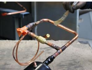
**Double vernissage** des tuyauteries en cuivre et des brasures des composants du circuit frigorifique
